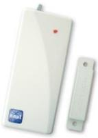
Se trata de una alarma de contacto magnético. Permite alertar a los profesionales del centro cuando se produce la apertura de una puerta con acceso restringido. Cuenta con sistema de control de franja horario para anular el servicio (ejemplo: durante el día, de 8:00h a 22:00h - inactivo). (Esta unidad es inalámbrica)
