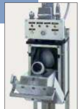
Estación de carga de metal
